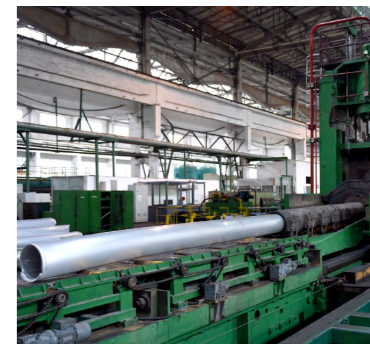
12500吨卧式挤压机水改油后进行生产
